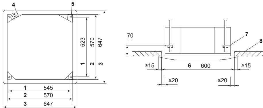
1 — петли крепления внутреннего блока; 2 — размеры внутреннего блока; 3 — размеры панели внутреннего блока; 4 — трубопроводы; 5 — петли крепления (x4); 6 — отверстие в потолке; 7 — шпильки в ушах крепления внутреннего блока; 8 — фальш-потолок
