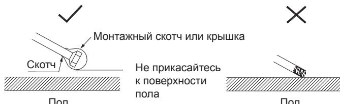
3. Отрезайте трубу и удаляйте заусеницы, направив обрабатываемый конец вниз.
