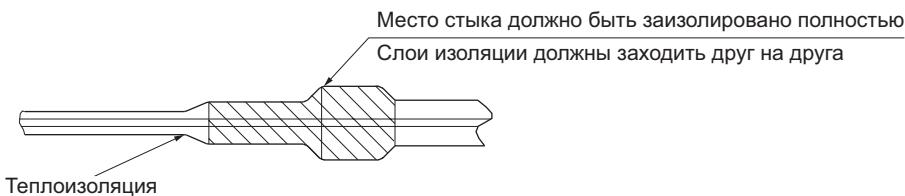
Теплоизоляцию закрепите монтажным скотчем.
