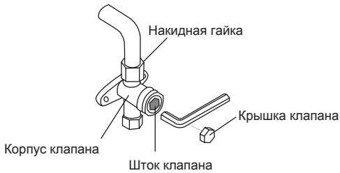
Используя шестигранный ключ, полностью откроите клапаны высокого и низкого давления. Затяните крышки клапанов на трех портах (сервисныйпорт, высокое давление, низкое давление) вручную. При необходимости вы можете затянуть его еще сильнее с помощью динамометрического ключа.
